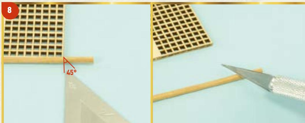
**8** Подготовленные вами рейки потребуются для изготовления комингсов люка. Отрежьте от реек четыре фрагмента нужных размеров, а затем обрежьте их концы под углом  $45^\circ$  (см. фотографию).
