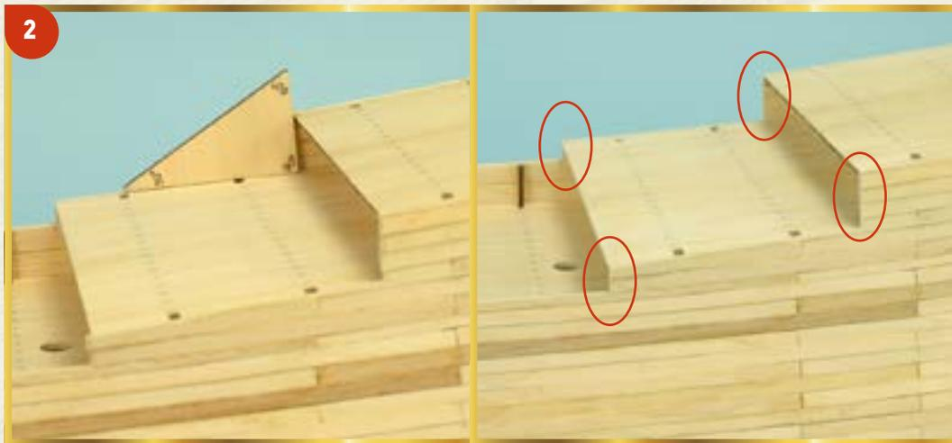
**2** Аналогичным образом обработайте концы планок, указанные на данной фотографии. Они должны быть вровень с передними краями настилов соответствующих палуб и образовывать прямые углы с расположенными ниже планками обшивки.
